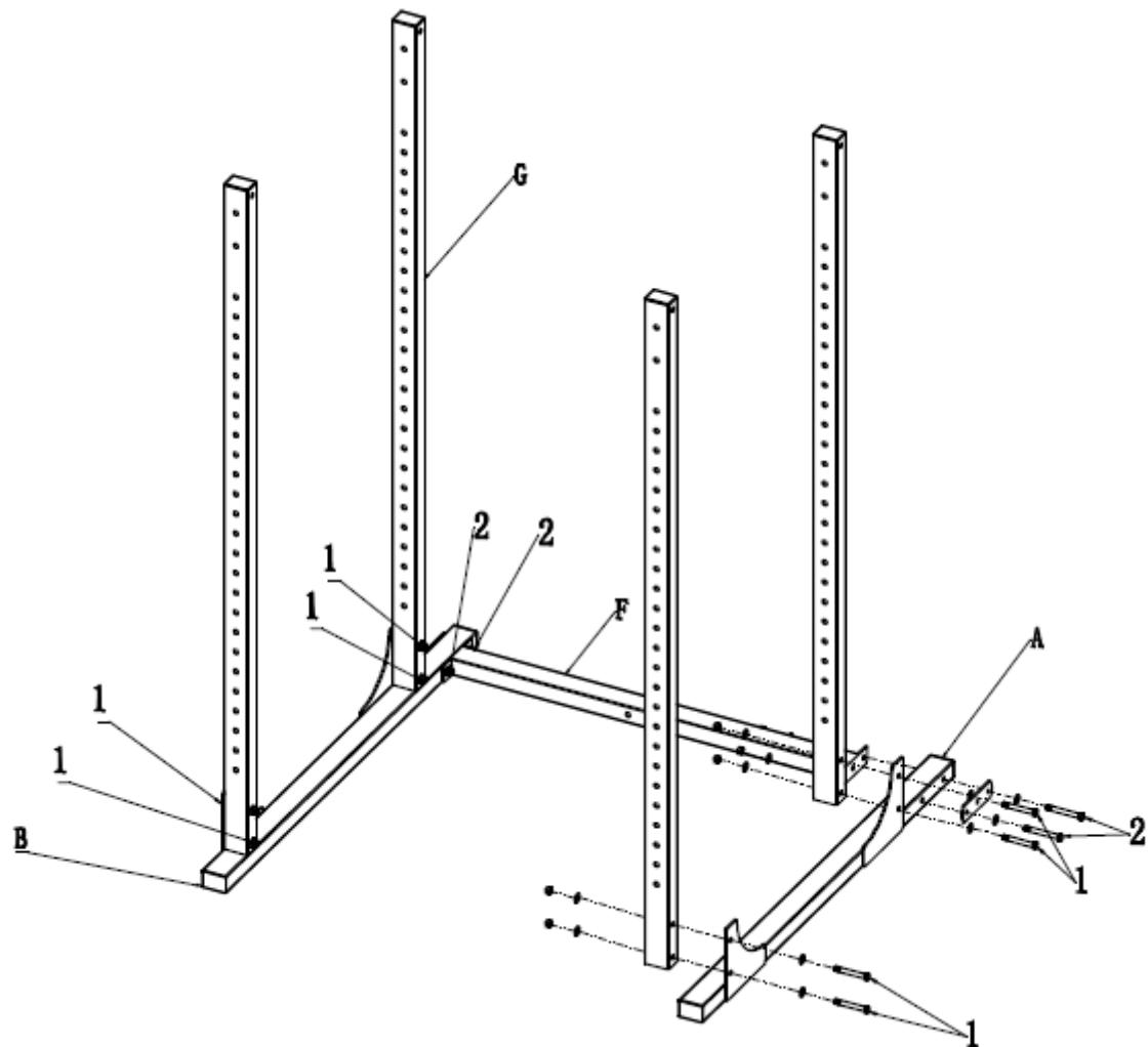
Matice jsou opatřeny silikonovým pojistným kroužkem, proto je řádně přitáhněte pomocí klíče.
