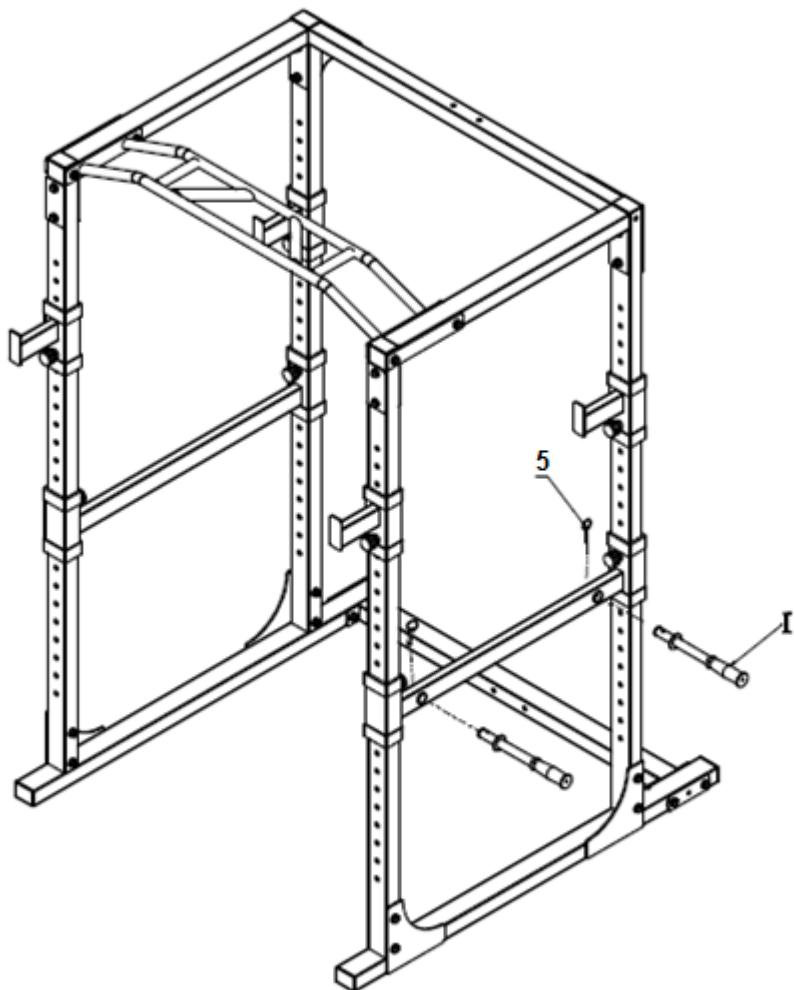
Matice jsou opatřeny silikonovým pojistným kroužkem, proto je řádně přitáhněte pomocí klíče.
