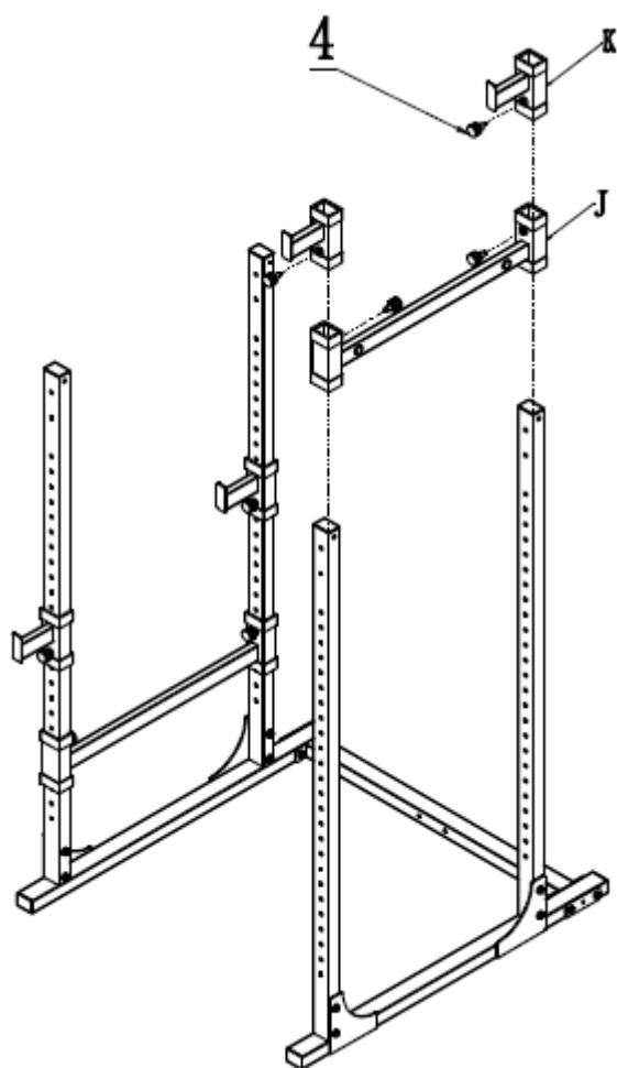
Matice jsou opatřeny silikonovým pojistným kroužkem, proto je řádně přitáhněte pomocí klíče.
