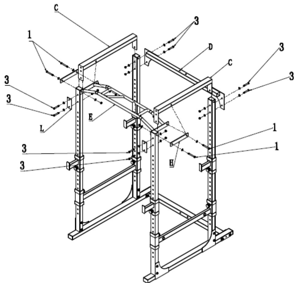
Matice jsou opatřeny silikonovým pojistným kroužkem, proto je řádně přitáhněte pomocí klíče.
