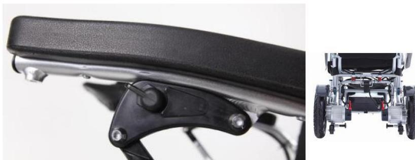
Lösen Sie den hinteren Träger, entfernen Sie die U-Schnalle.
